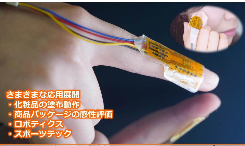
新原理による裏面照射式触覚センサを開発する。キャリブレーションや多チャネル化技術によって高精度化し、応用展開する。
